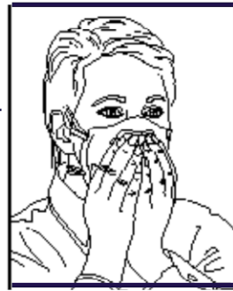
Figura 6. Ajuste de protección respiratoria Tomada y adaptada de multimedia.3m.com. Consultado en https://multimedia.3m.com/mws/media/888288O/ficha-tecnica-3m-respirador-desechable-8210v.pdf
